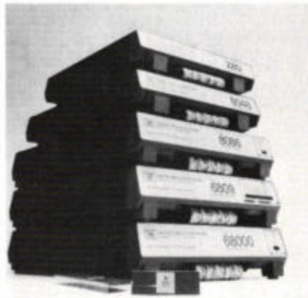
Emulatorprobes zijn onmisbaar voor adaptatie van het ontwikkelsysteem aan de gewenste microprocessor. Hier een aantal type-adapters van het HP64000-systeem voor resp. de Z80, 8040, 8086, 6809 en de 68000.
