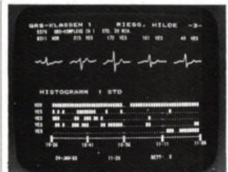
Afb. 8. Per patiënt beschikt Arrhycomp over een opslagmogelijkheid voor 10 complexvormen, te presenteren in twee beeldpagina's van 5 vormen. Een histogram toont de tijdstippen waarop die vormen zijn opgetreden.
