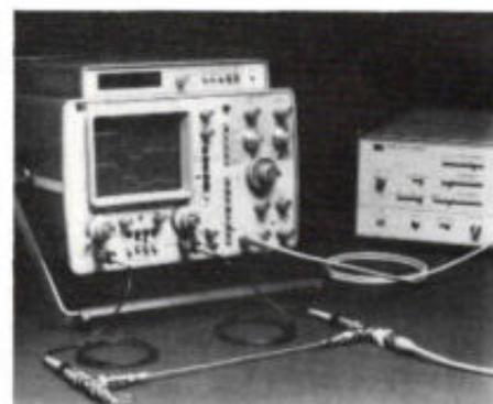
Meetopstelling voor bepaling van de vertraging van een coaxiaal kabelstuk; in dit geval wordt voor een kabellengte van 10 cm een vertraging gemeten van -1,43 ns, digitaal aangegeven op het display. Het minteken is een indicatie dat het signaal op kanaal A later arriveert dan het signaal op kanaal B.
